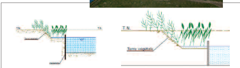
Techniques végétales protégées par un rideau de palplanches
