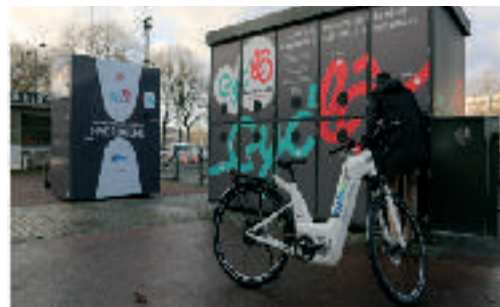
Vélo et station hydrogène dédiée et garage à vélos – 100 km d'autonomie
